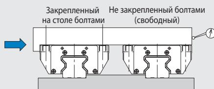
Два рельса должны быть расположены параллельно друг другу, так чтобы не было приложено никакой моментной нагрузки; измерение жесткости производится, когда один рельс не закреплен болтами.
